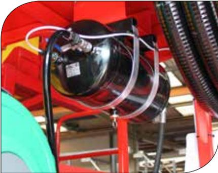
Tank mit Überdrucksicherung
