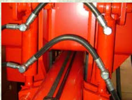
Hydraulische Deichselfederung: Federung mit Stickstoffdämpfer.
