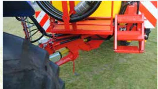
Automatischer Nachlauf durch Deichsel lenkung, manuell zu bedienen, mit automatischer Mittenrückstellung.
