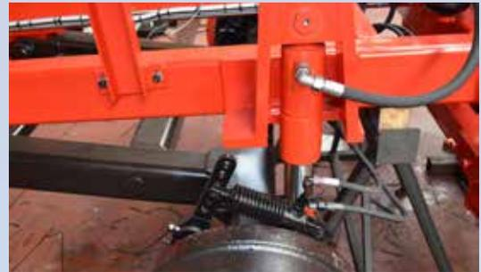
Die hydropneumatische Federung wird automatisch niveaureguliert, so dass die Zylinder den optimalen Federweg haben. Auf starrem Rahmen montiert, so dass keine Rollbewegung entsteht.
