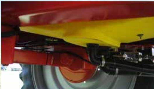
Zur maximalen Minderung von Sprühwasser-Restmengen gibt es unter dem Tank einen doppelten Ablauf.
