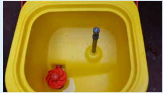
Einfüllschleuse mit großem Fassungsvermögen neben dem Bedienpanel; auch für schnelles und leichtes Mischen von Pflanzenschutzmitteln in Pulverform geeignet.
