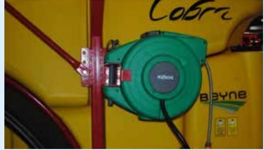
Schlauchrolle mit 20 m Schlauch und Reinigungsdüse zur Außenreinigung (bis zu 10 Bar Druck).
