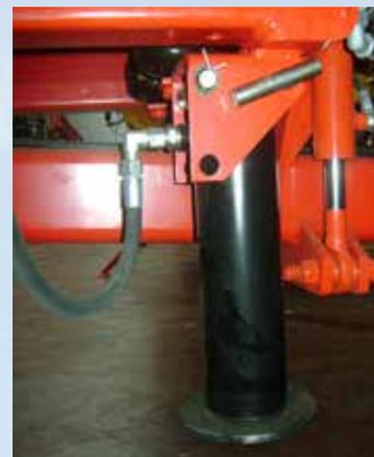
Hydraulischer Stützfuß: fährt automatisch ein; mit Handpumpe oder direkt auf dem Schlepper zu bedienen.
