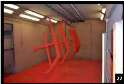
Die Lackschicht weist mindestens eine Schichtdicke von 120  $\mu\text{m}$  auf. Zusammen mit der Metallisierung entsteht eine Lackschicht von mindestens 160  $\mu\text{m}$ .
