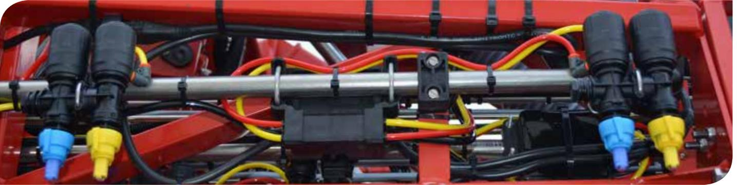
In Kombination mit pneumatischer Düsenschaltung ein automatisches System für die Wahl der richtigen Düse.
