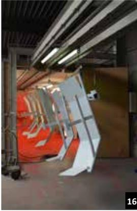
Anschließend werden die Teile aufgehängt und positiv geladen. Das Pulver ist negativ geladen und wird auf das Metall aufgebracht. Durch die elektrische Aufladung wird eine gleichmäßige Verteilung erreicht.
