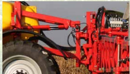
Bei dem Modell Python wird das Spritzgestänge über ein Parallelogrammsystem aufgehängt, das hydropneumatisch gefedert ist, so dass Spritzgestänge und Spritzbild optimal bleiben.
