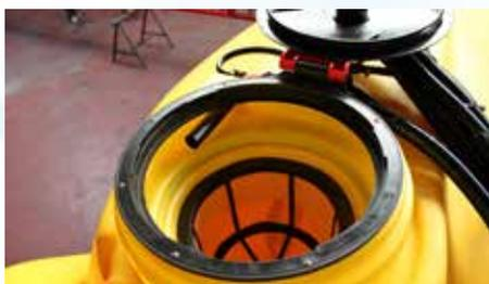
Zugänglicher Einfülldom mit Behälterreiniger zur Reinigung von Verpackungen; dank dazugehörigem Druckregler leicht zu bedienen.
