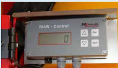
Gut sichtbare, digitale Füllstandsmessung; gibt Tankinhalt korrekt wieder. Als Option programmierbar, so dass man immer bis zum gewünschten Tankinhalt auffüllen kann.
