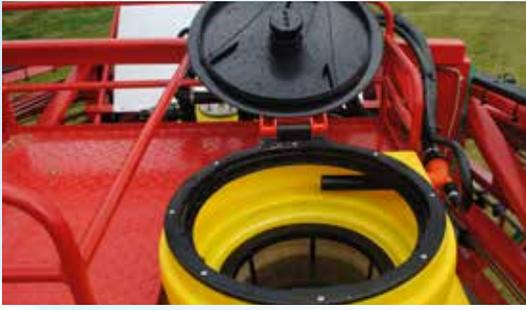
Zugänglicher Einfülldom mit Behälterreiner zur Reinigung von Verpackungen; dank dazugehörigem Druckregler leicht zu bedienen.
