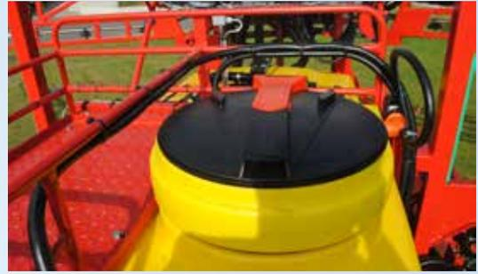
Einfülldom mit leicht zugänglicher Plattform zur Lagerung von Pflanzenschutzmitteln.
