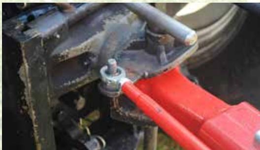
Leicht einzustellende Lenkung über verstellbare Lenkstange (vollständig mechanische Übertragung).
