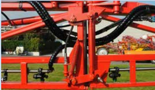
Alle Elemente des Spritzgestänges sind dank der einstellbaren Haken verriegelt, wodurch die Pendelwirkung auf ein Minimum reduziert wird.
