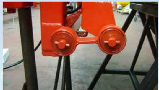
Die Pendelwirkung wird dank der Dämpfung durch Silentblocs aufgefangen. Das sorgt für ein jederzeit stabiles Spritzgestänge.
