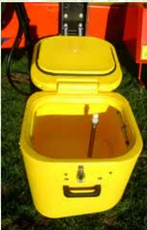
Einfüllschleuse mit großem Fassungsvermögen neben dem Bedienpanel; auch für schnelles und leichtes Mischen von Pflanzenschutzmitteln in Pulverform geeignet.
