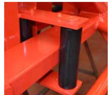
Die Führung der sich bewegenden Teile erfolgt über Kunststoffrollen. Das Material ist sehr verschleißfest und beschädigt das Spritzgestänge nicht.
