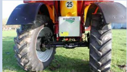
Die automatische Achsschenkellenkung wird proportional angesteuert, sodass die Räder der Spur des Zugfahrzeugs exakt folgen.
