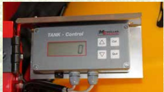
Gut sichtbarer, digitaler Füllstandsmesser; zeigt den korrekten Tankinhalt an. Als Option programmierbar, so dass man immer bis zum gewünschten Tankinhalt auffüllen kann.
