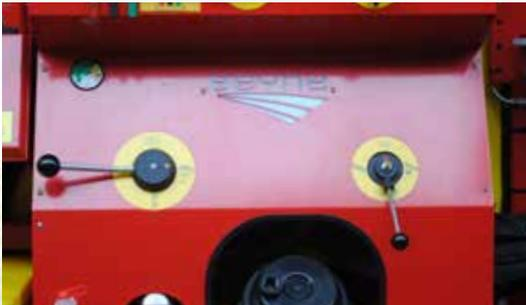
Übersichtliches Bedienpanel: leichte Bedienung aller Funktionen; als Option elektrische Bedienung aus der Kabine.
