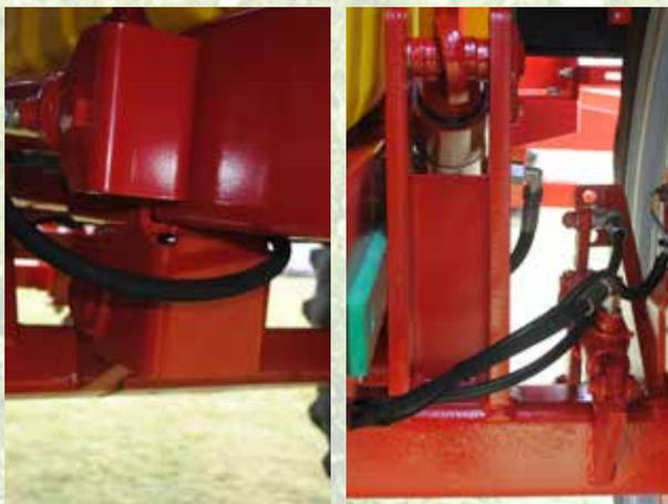
Die hydropneumatische Federung wird automatisch niveaugeregelt, so dass die Zylinder den optimalen Federweg haben. Auf starrem Rahmen montiert, so dass keine Rollbewegung entsteht.
