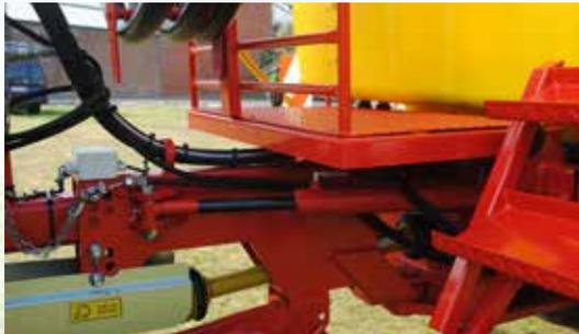
Automatischer Nachlauf durch Deichsel lenkung mit 2 Zylindern.
