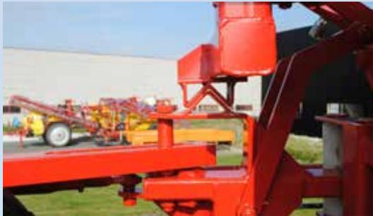
V-Blockierung des Spritzgestänges: dank der Führungen wird das Spritzgestänge bei vollständigem Anheben zentriert und lässt sich somit leichter einklappen.
