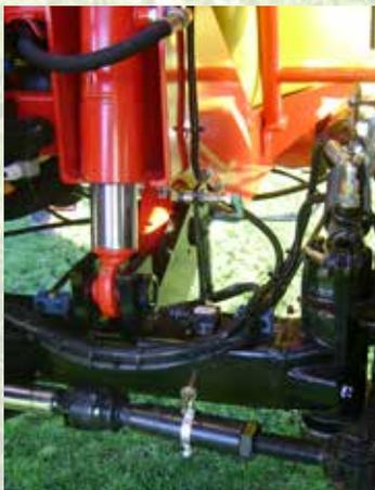
Die hydropneumatische Federung wird automatisch niveaureguliert, so dass die Zylinder den optimalen Federweg haben. Auf starrem Rahmen montiert, so dass keine Rollbewegung entsteht.
