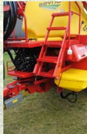
Automatischer Nachlauf durch Deichselnlenkung, manuell zu bedienen, mit automatischer Mittenrückstellung.
