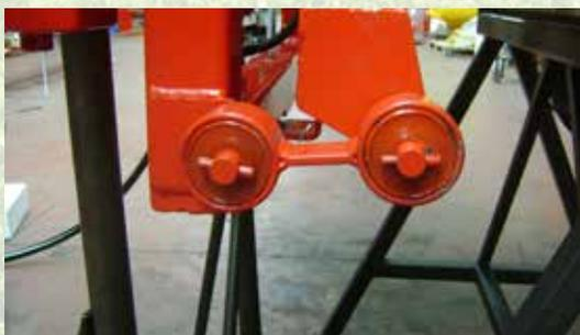
Die Pendelwirkung wird dank der Dämpfung durch Silentbloccs aufgefangen. Das sorgt für ein jederzeit stabiles Spritzgestänge.
