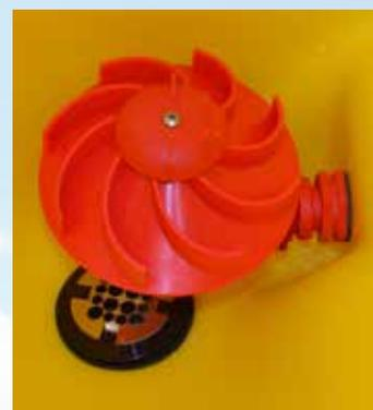
Dank des Hochdruck-Mischkopfes in der Einfüllschleuse bildet sich ein Strudel, mit dem Pflanzenschutzmittel in Pulverform leicht vermischt werden können.
