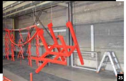
Anschließend werden die Teile bei 215  $^{\circ}\text{C}$  im Ofen behandelt. Mit diesem Verfahren erreichen wir eine sehr hohe Lackqualität, die auch gegen flüssige Düngemittel resistent ist.
