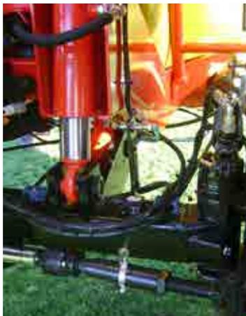
La suspension hydropneumatique de l'essieu se règle automatiquement en fonction de la charge. Monté sur compas rigide afin d'éviter tous mouvements de roulis.
