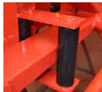
Le guide du balancement de la rampe est réalisé avec des rouleaux en Ertalon. Cette matière est très résistante et n'altère pas la structure en acier.
