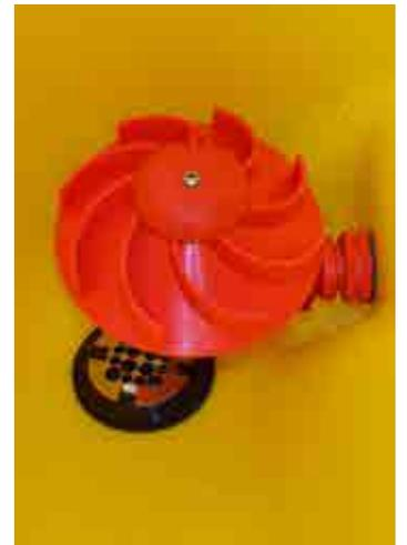
Injection d'eau sous pression dans le fond de l'incorporateur de produits. Système "tourbillon" pour le mélange des produits en poudre.
