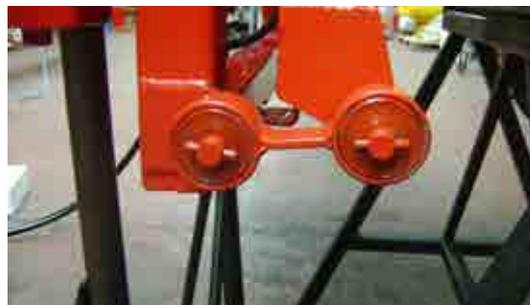
Double bâti avec silentbloks. Les mouvements du châssis sont ainsi absorbés et ne se répercutent pas sur le maintien de la rampe.
