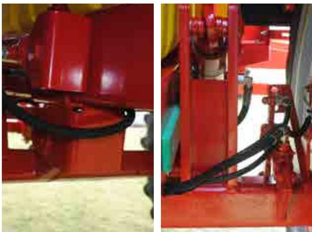
La suspension hydropneumatique de l'essieu se règle automatiquement en fonction de la charge. Monté sur compas rigide afin d'éviter tous mouvements de roulis.
