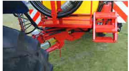
Timon suiveur, 3 fonctions: commande manuelle gauche-droite, suivi automatique et recentrage automatique.
