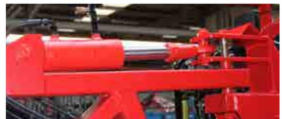
Les vérins de géométrie variable, pilotés individuellement, permettent de suivre parfaitement le terrain (option).
