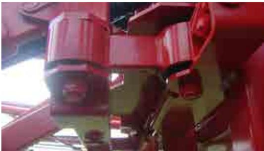
Double bâti avec silentblochs. Les mouvements du châssis sont ainsi absorbés et ne se répercutent pas sur le maintien de la rampe.
