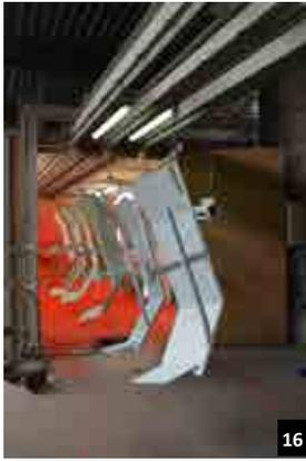
Ensuite, les pièces sont pendues sur un rail à courant négatif. La poudre est projetée sur le métal à l'aide d'un pistolet à courant positif, ce qui donne un résultat parfaitement uniforme.
