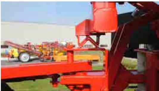
Les butées hautes triangulaires permettent le recentrage de la rampe avant de la repliée.
