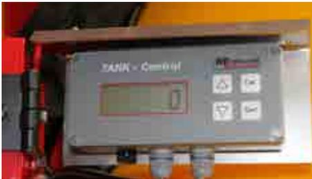
Jauge digitale, affichage continu du niveau de la cuve. Remplissage automatique programmable en option.
