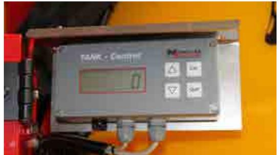
Jauge digitale, affichage continu du niveau de la cuve. Remplissage automatique programmable en option.
