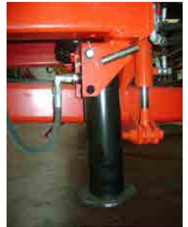
Cric hydraulique repliable sur sélecteur tracteur ou avec pompe manuelle en option.
