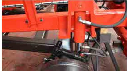
La suspension hydropneumatique de l'essieu se règle automatiquement en fonction de la charge. Monté sur compas rigide afin d'éviter tous mouvements de roulis.
