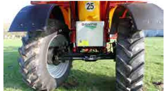
Les roues directrices, pilotées par gyroscope et distributeur électro-hydraulique proportionnel, assurent un suivi impeccable.
