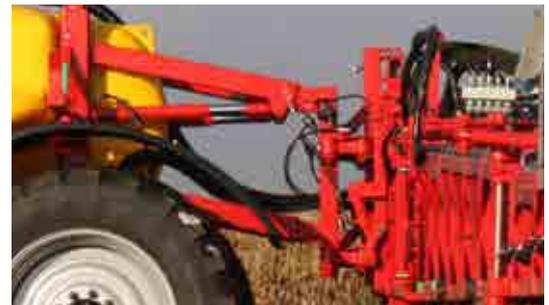
Sur le Python, la rampe est suspendue sur parallélogramme avec boules d'azote.
