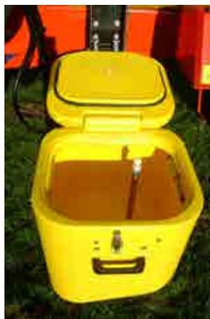
Trémie d'incorporation de produits avec système de rinçage des emballages.
